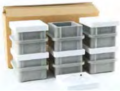
55-C0100/P156 Paquete de seis unidades de moldes de plástico KUBO 15 para muestras de 150 mm. Todos los moldes se suministran completos con cubierta de poliestireno, placa base y obturador.
