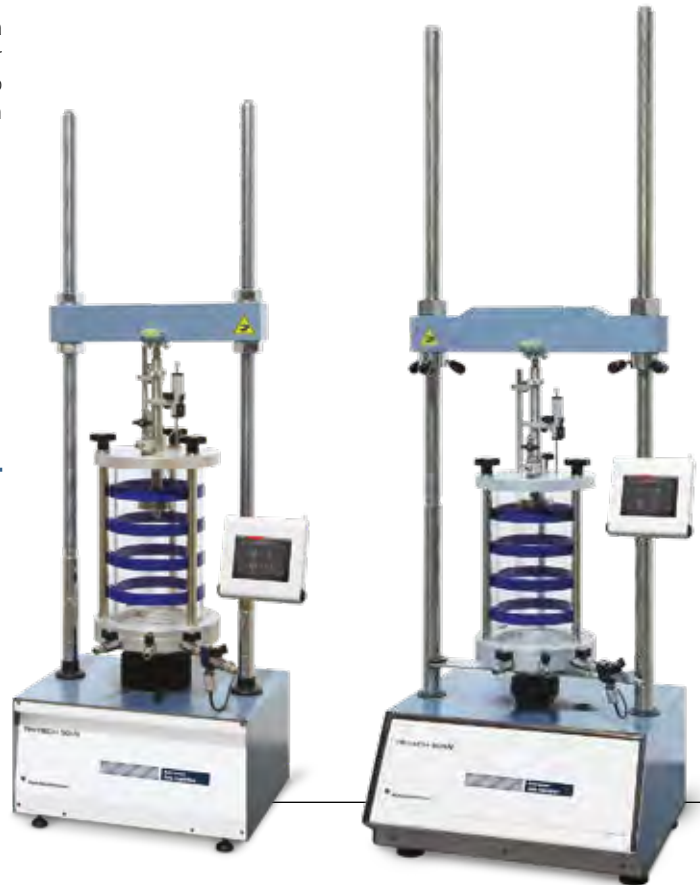
TRITECH 50 y TRITECH 100 con 4 canales incorporados, equipados con célula triaxial acanalada provista de célula de carga sumergible y transductores de presión intersticial
