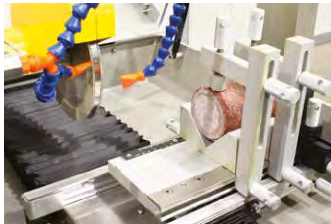
32-D0536/A, detalle del eje con mecanismo de sujeción y disco de esmerilado de dos caras 32-D0536/A3 durante el pulido de la superficie de extremos de muestras cilíndricas
