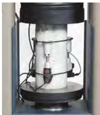
Tres compresímetros-extensómetros 55-C0222/G acoplados a una muestra cilíndrica durante la etapa de la compresión.
