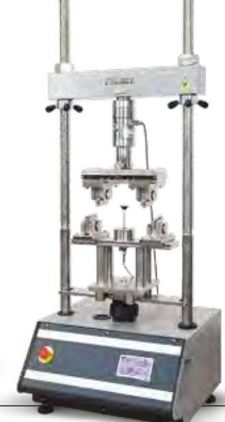
70-T1192 con accesorios para realizar ensayos de flexión en cemento reforzado con fibra de vidrio según la norma EN 1170-5
