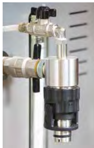
Detalle de la conexión rápida para el matraz evaporador rotatorio, para el muestreo de soluciones de betún. (Accesorio)
