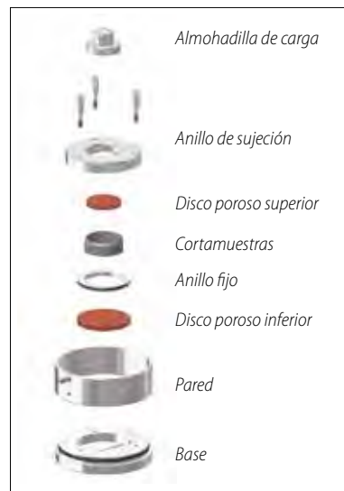
Vista ampliada de la célula de consolidación 26-WF0320
