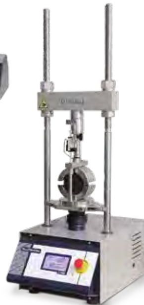
MULTISPEED 34-V1172 equipado con accesorios digitales para ensayos Marshall
