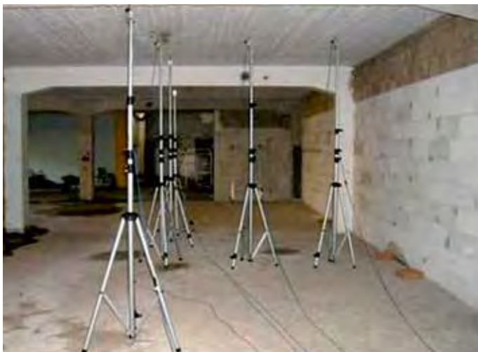
Instrumentación digital para la medición de deflexión de estructuras, sistema completo con 3 elementos de medición adicionales
