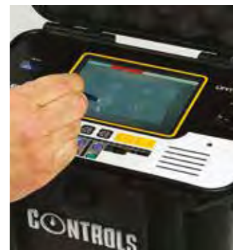
Sistema de registro de datos de 8 canales DATALOG 8 que funciona con batería integrada, con maleta de transporte rígida, adecuado para su uso in situ . Pantalla táctil gráfica a color de 5,7"
