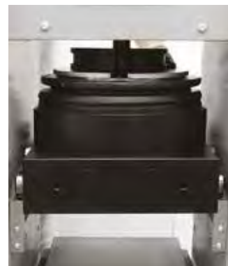
Detalle de la operación de deslizamiento del plato superior y del asiento esférico
