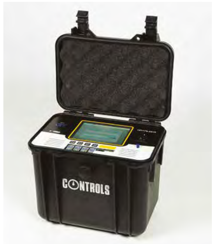
Unidad de adquisición de datos DATALOG 8 modelo 82-P9008/F. Versión de funcionamiento con batería diseñada para aplicaciones in situ
