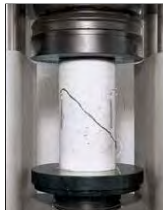
Determinación del módulo elástico utilizando galgas extensométricas montadas en la superficie
