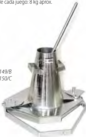
54-C0149/B, 54-C0150/C durante su uso. El asa sobresale por encima de la muestra y el asentamiento se mide mediante la varilla apisonadora, que está graduada en pasos de 1 cm.
