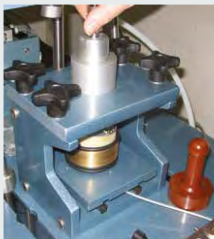
Preparación de muestras con sufridera de madera incluida en la máquina.
