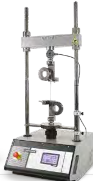
70-T1182/T con accesorios para ensayos de tracción en alambres de acero
