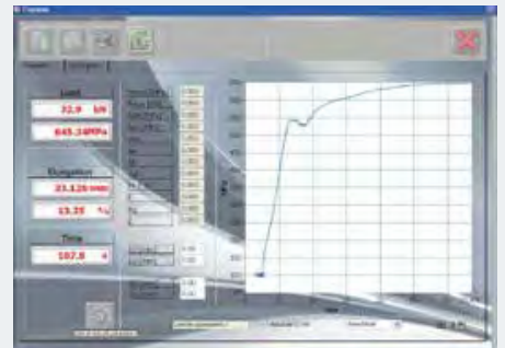
Ejecución del ensayo de tracción
