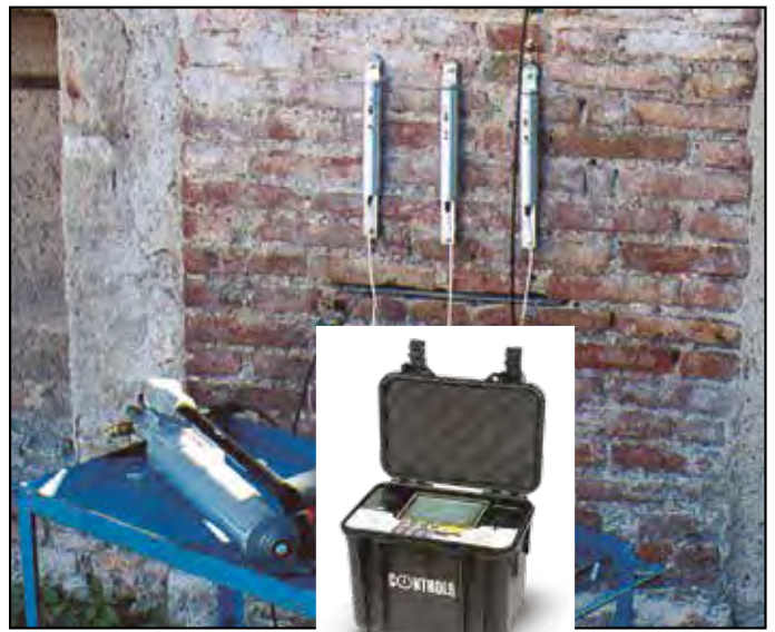
Aplicación típica con tres configuraciones digitales compuesta por 3 transductores electrónicos tubulares 58-D0585, conjunto de bomba 58-D0568 equipado con transductor de presión 82-P0050, cable apropiado P0349/ELT y DATALOG 8 82-P9008 para una adquisición completa de los datos.
