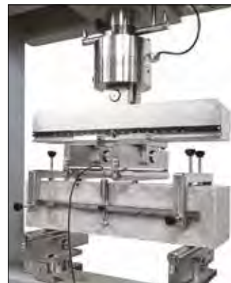
Ensayo de deflexión de la viga en hormigón FRC según la norma ASTM C1609
