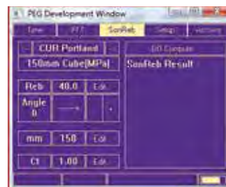
Menú SonReb para evaluar la resistencia del hormigón combinando las mediciones ultrasónicas y del esclerómetro
