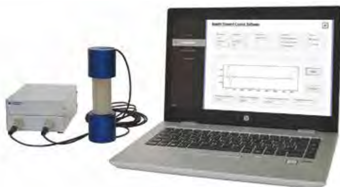
Configuración de los Bender elements que ofrece la posibilidad realizar el ensayo con la muestra sin utilizar células triaxiales
