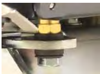
Detalle del dispositivo mecánico de 3 puntos para ajustar con precisión el hueco entre el recipiente y la paleta conforme a las normas
