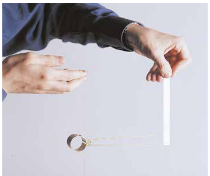
Uso del aparato de extensibilidad del molde 62-L0025/4, incluido con el kit 62-L0025/B
