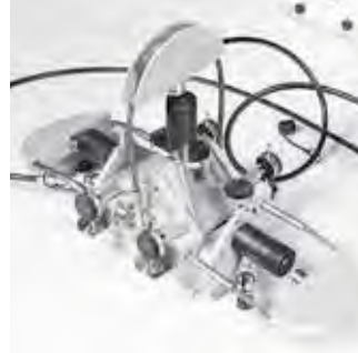
32-D0548/A: Detalle del aparato de caja de corte equipado con 5 indicadores digitales (4 verticales y 1 horizontal)
