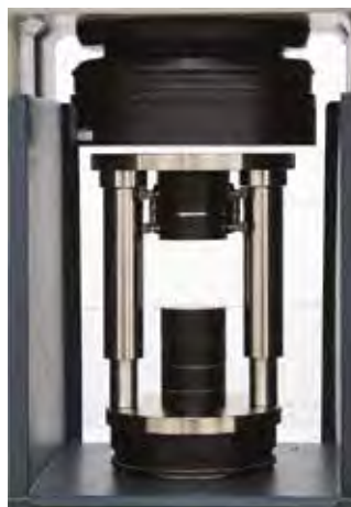
Dispositivo de compresión para muestras de roca modelo 32-D9035 montado dentro de una máquina de compresión CONTROLS
