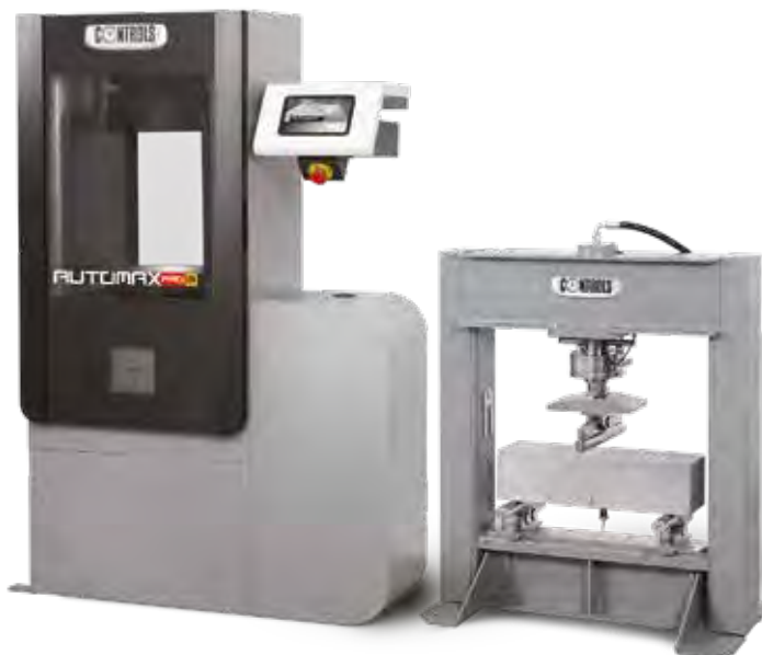
Ensayo CMOD realizado en el bastidor de flexión de 200 kN C1511/FR controlado por el sistema AUTOMAX PRO-M actualizado con 50-FW/DC.
