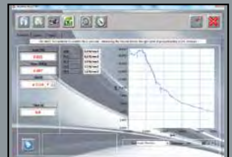
Captura de pantalla del software 82-SW/DC para realizar ensayos bajo control por desplazamiento para la caracterización de FRC
