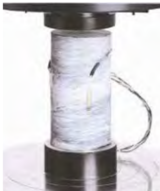
Muestra de roca con galgas extensométricas 82-P0390 acopladas
