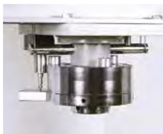
Detalle de la célula de carga y del transductor de desplazamiento de recorrido del pistón 50-C1500/9
