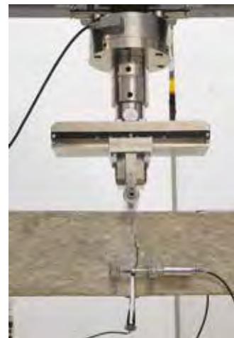
Ensayo CMOD según la norma EN 14651 con medición CTOD
