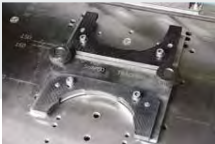
Dispositivo para muestras para ensayos de máquinas de pista, flexión semi-circular y Disk Shaped Compact Tension
