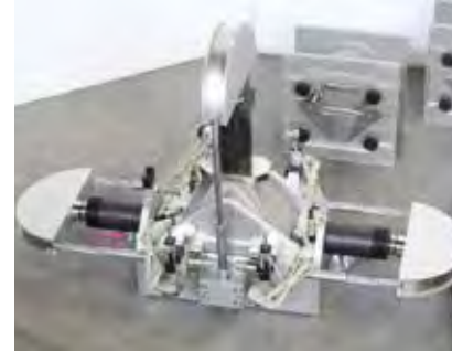
32-D0548/D: Detalle del aparato de caja de corte equipado con 5 transductores de desplazamiento
