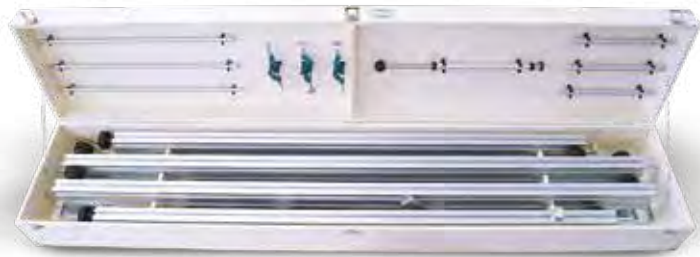
Barra de medición completa de 5,5 metros de largo y soportes ajustables para los dispositivos de desplazamiento alojados en el interior de la maleta de madera
