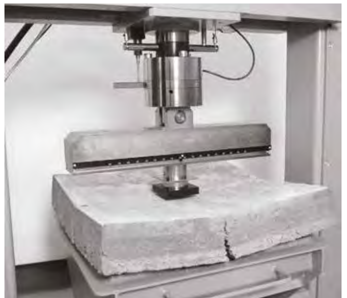
Ensayo de losas cuadradas de FRC según la norma EN 14488-5 en el bastidor de flexión DUPLEX de 350 kN 50-C1701/FR
