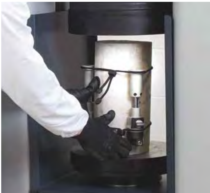
Determinación del módulo elástico con la máquina de compresión Automax Pro-M 3000 kN EN, actualizada con 50-FW/EM.
