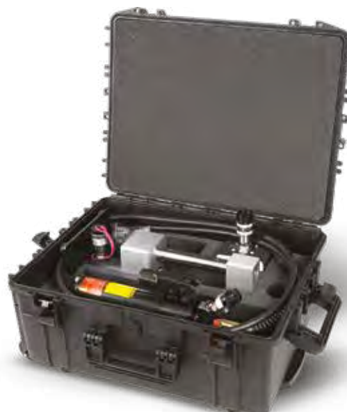
Aparato digital para mediciones de carga puntual de rocas alojado en la práctica y resistente maleta de transporte con ruedas que facilita su transporte. Peso total 22,3 kg.
