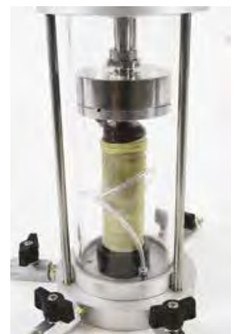
Detalle de una célula triaxial estándar provista de célula de carga sumergible
