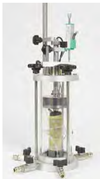
Célula triaxial estándar provista de célula de carga sumergible y transductor de desplazamiento
