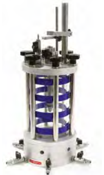
Célula triaxial acanalada 28-WF4070 con kit de actualización 28-WF4070/ADV para su uso con bender elements y transductores de deformación locales
