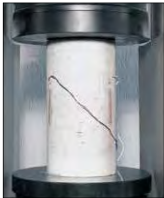
Determinación del módulo elástico utilizando galgas extensométricas montadas en la superficie
