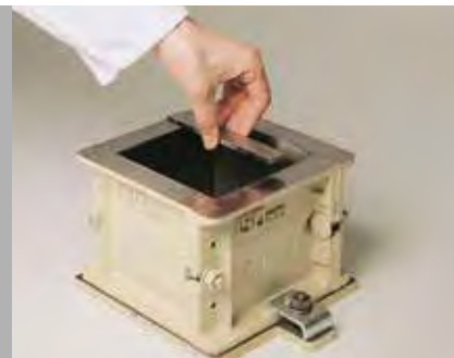
Verificación de un molde cúbico con indicadores de pasa-no pasa
