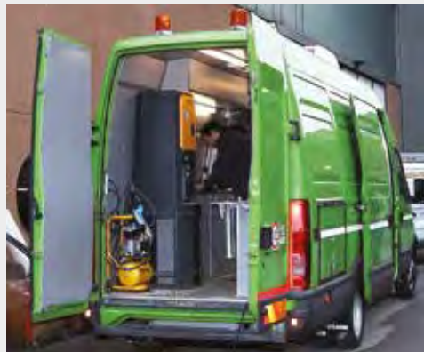
Ejemplo de ensayo en carreteras AUTOLAB. A la izquierda nuestro compactador giratorio.
