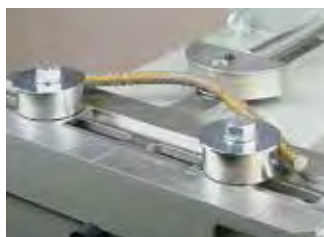
Detalle del enderezamiento
