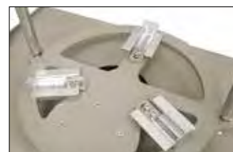
Detalle de la base ajustable para tamices con un diámetro de entre 200 y 450 mm
