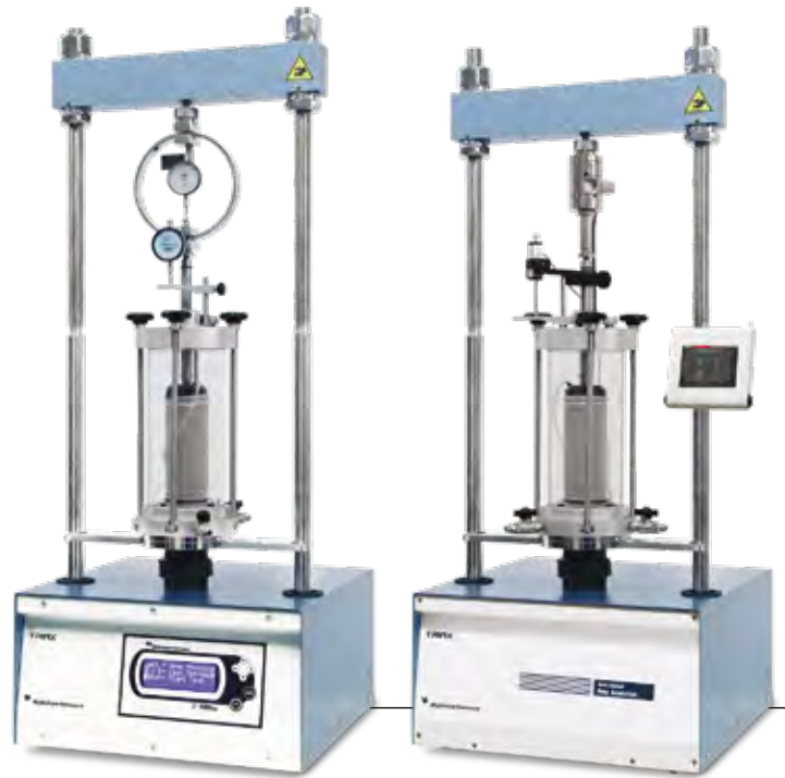
TRIAX equipado con célula triaxial estándar, reloj comparador y anillos dinamométricos; TRIAX con 4 canales incorporados con célula triaxial estándar, célula de carga externa y transductor de desplazamiento.
