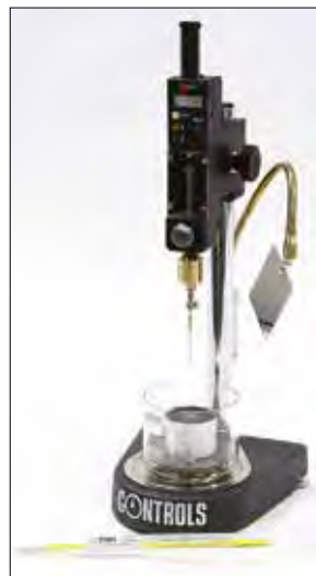
81-B0100/D con aguja, espejo, bandeja de transferencia de vidrio, vaso para muestras y termómetro
