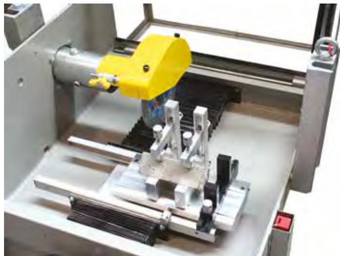
32-D0536/A, detalle del eje con mecanismo de sujeción y hoja de corte 32-D0536/2
