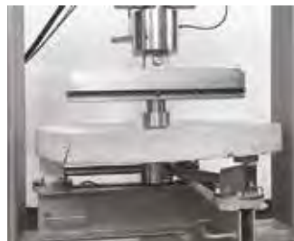
Ensayo de losas según la norma ASTM C1550 en el bastidor de flexión SIMPLEX de 350 kN 50-C1711/FR
