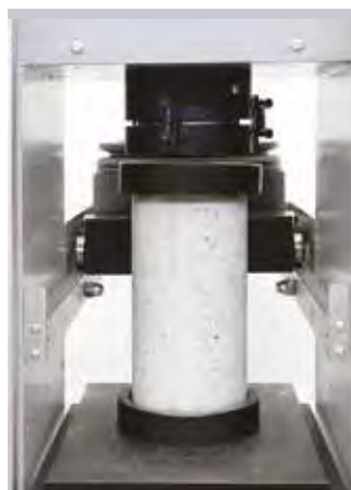
Detalle de la máquina equipada con el juego de conversión 50-A29/CYL para ensayos con cilindros
