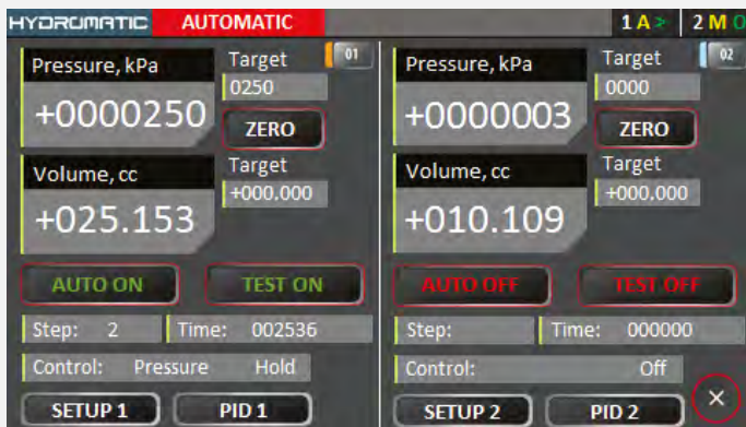
Control automático: Ejecución automática de los pasos programados de cambio de presión o volumen
