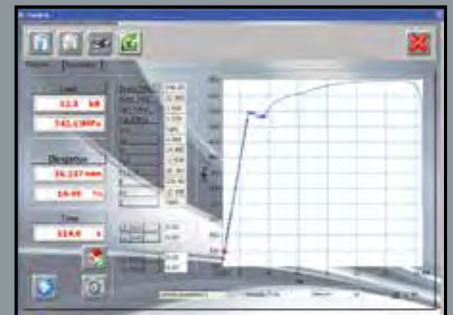
Captura de pantalla del software 82-SW/UTS para ensayos de tracción en barras de refuerzo de acero
