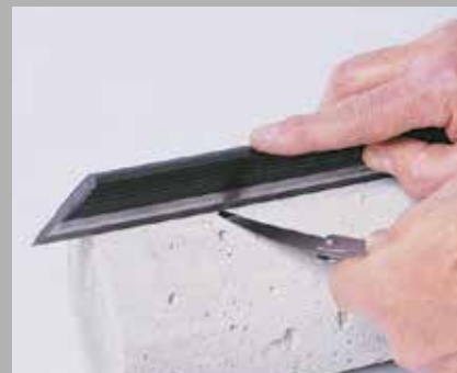
Verificación de la rectitud usando el reglón 82-C0108/1 y juego de galgas de grosores 82-C0110/1
