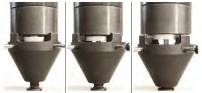
Detalle del sistema de posicionamiento del peso donde se muestra, de izquierda a derecha, la fase de sin carga, la fase de precarga (25 N) y la fase de carga (525 N). El sistema permite la transición de la fase de sin-carga a la de pre-carga y después a
