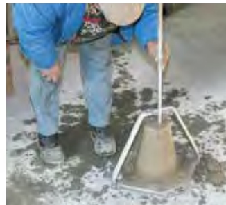
54-C0149/B, 54-C0150/C durante su uso. El asa sobresale por encima de la muestra y el asentamiento se mide mediante la varilla apisonadora, que está graduada en pasos de 1 cm.
