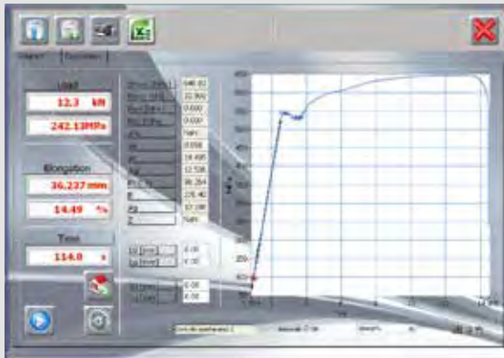
Ejecución del ensayo de tracción
