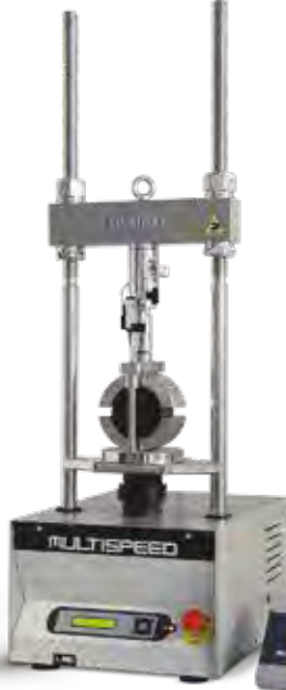
34-V1072 Con accesorios de ensayo Marshall (modo digital)
