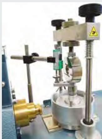
Detalle de Shearmatic EmS equipada con accesorios y célula de consolidación para la realización automática del ensayo de consolidación
