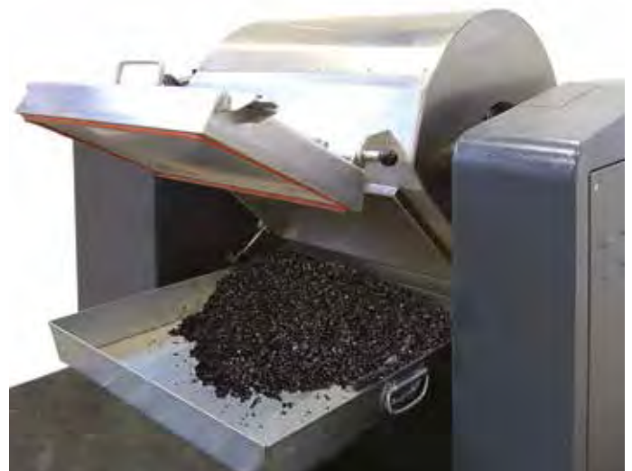
Detalle de la descarga: el cilindro de mezclado gira mediante un sistema de inclinación motorizado para facilitar la descarga. El ángulo de inclinación se ajusta a 130° para acelerar el proceso de descarga.
