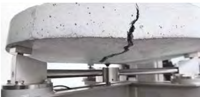
Ensayo de losas según la norma ASTM C1550 en el bastidor de flexión SIMPLEX de 350 kN 50-C1711/FR
