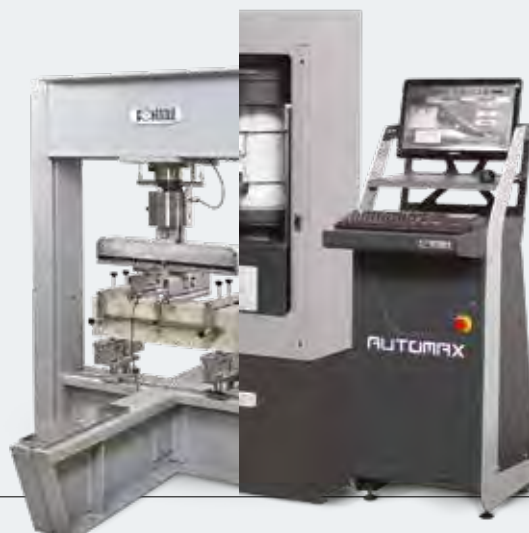
AUTOMAX Multitest 50-C20M82 que controla un bastidor de flexión doble de 350 kN para ensayos FRC con el paquete de software 82-SW/DC
