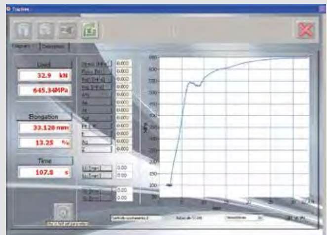
Ejecución del ensayo de tracción
