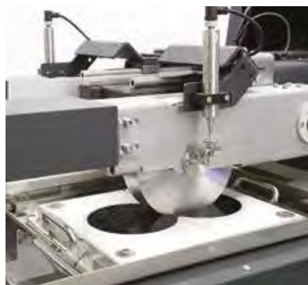
Detalle de las ruedas de ensayo con transductores de medición de profundidad del surco montados axialmente y alineados con el centro de la rueda
