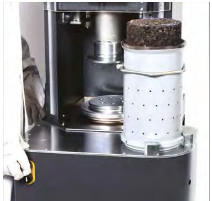
Superficie de trabajo integrada con extractor electromecánico 78-PV2520/15
