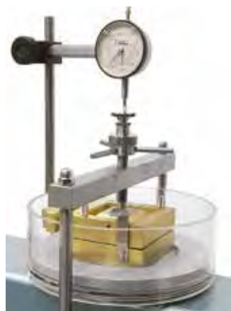
Detalle de la carcasa de la caja de corte montada en modo analógico
