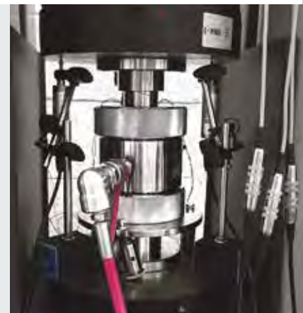
Célula de Hoek y 3 transductores de desplazamiento externo para ensayos triaxiales automáticos con trayectoria de tensión multifase y análisis después del valor máximo
