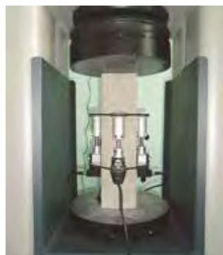
Tres compresímetros-extensómetros 55-C0222/F acoplados a una viga de hormigón
