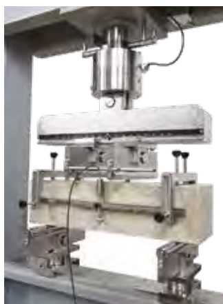
Ensayo de deflexión de vigas según la norma ASTM C1609, que incluye dos transductores de desplazamiento LVDT de alta precisión y un bastidor auxiliar
