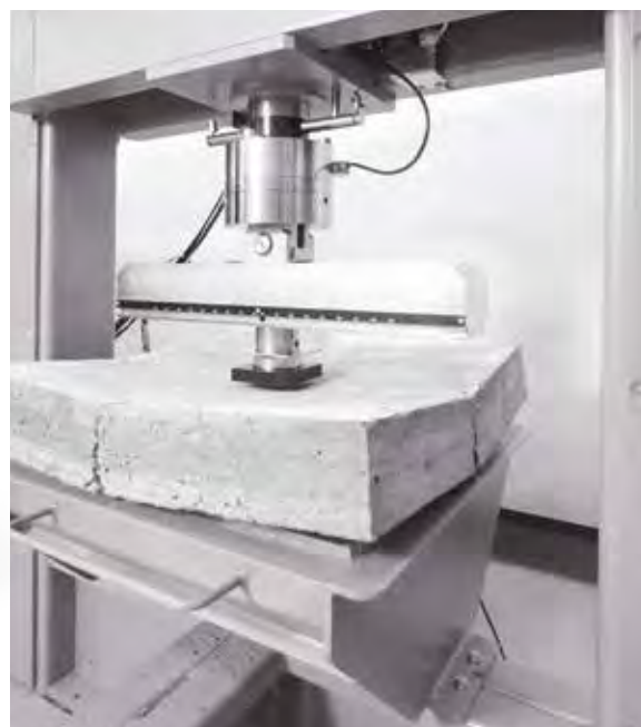
50-C1701/FR con C1500/6 y C1500/8 para ensayos de planchas cuadradas según la norma EN 14488-5
