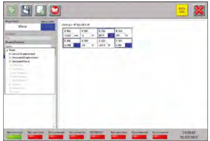
Asignación de canales (célula de carga, transductor de desplazamiento vertical y transductor de desplazamiento horizontal) y plantillas, para realizar un ensayo de corte directo con procesamiento de datos en tiempo real utilizando nuestras plantillas de Geoanálisis
