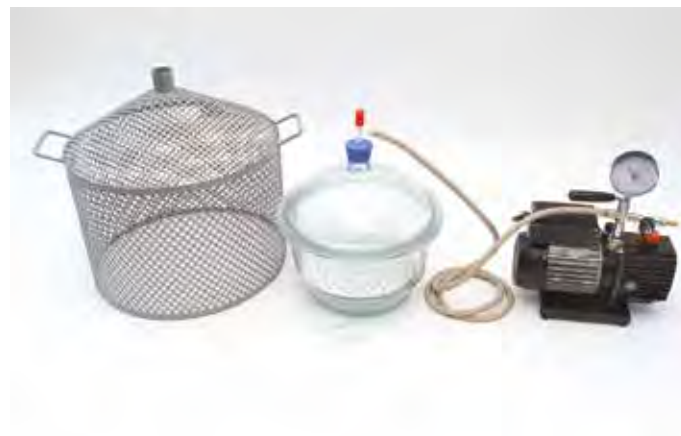
86-D1112/A con dos picnómetros 86-D1126, bomba de vacío, caja de seguridad 86-D1113/1 y accesorios.
