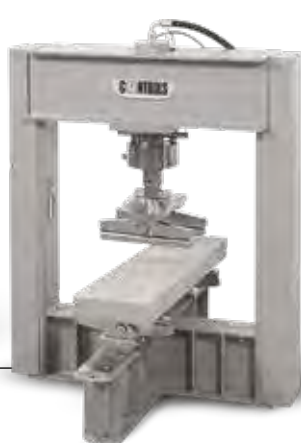
50-C1511/FR con rodillos 50-C1500/1 para ensayos en vigas de hormigón de hasta 650 mm de longitud en modo paralelo
