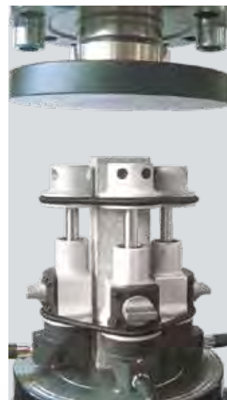
Tres compresímetros-extensómetros 55-C0222/G acoplados a un prisma de mortero de 40 x 40 x 160 mm
