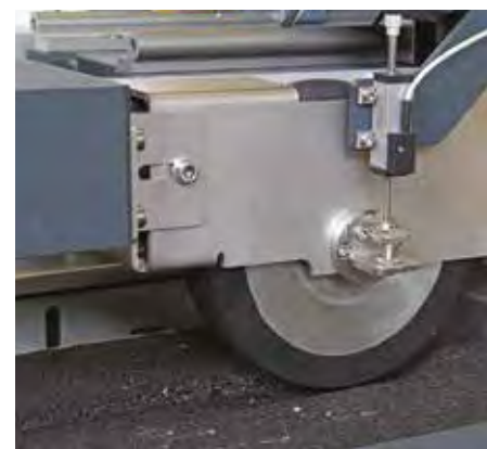
Detalle de las ruedas de ensayo con transductores de medición de profundidad del surco montados axialmente y alineados con el centro de la rueda
